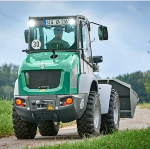
Essieu avant directionnel pour une sécurité accrue lors des déplacements entre les chantiers.
