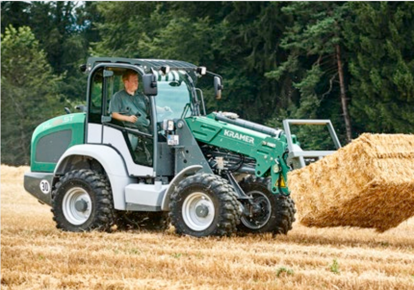
Essieu avant directionnel pour une sécurité accrue lors des déplacements entre les chantiers.
