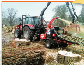
Grue entraînée sur 3 points tracteur avec entraînement hydraulique
