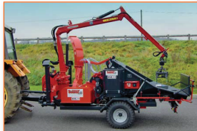
Grue montée sur le broyeur
