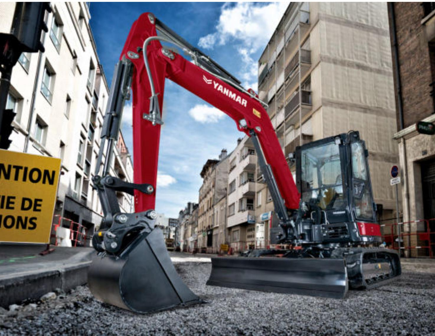
Grâce à une chaîne cinématique améliorée comprenant un moteur Stage V plus puissant avec FAP, une augmentation de 14 % des performances de la pompe hydraulique et un nouveau distributeur, les temps de cycle ont été améliorés de plus de 10 % par rapport au modèle précédent.
