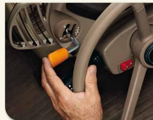
**Changez rapidement et facilement de sens de marche** grâce à l'inverseur placé à gauche. L'inverseur de marche de la transmission "AutoPowr" est doté d'une fonction d'immobilisation active qui permet de maintenir le tracteur à l'arrêt. Vous pouvez ainsi gerber des charges avec toute sérénité.
