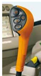
**Une toute nouvelle commande électrique de débrayage** pour les transmissions PowerQuad Plus et AutoQuad Plus permet un changement de gamme en marche, rapide et simple.
