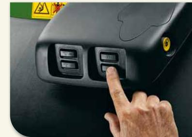
Les commandes extérieures du relevage arrière et de la prise de force facilitent l'attelage des outils. La commande du troisième point hydraulique est disponible en option.
