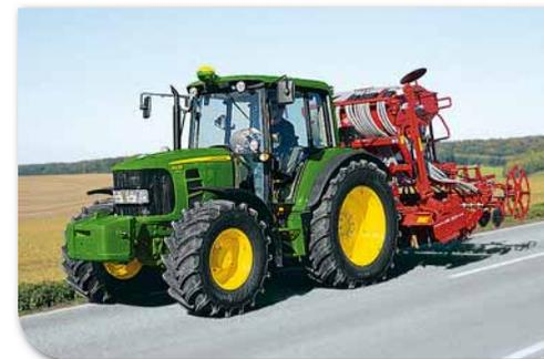
*La capacité de relevage autorise l'utilisation des outils les plus lourds. La commande hydraulique du troisième point vous permet d'adapter la géométrie à la fonction des outils.*
