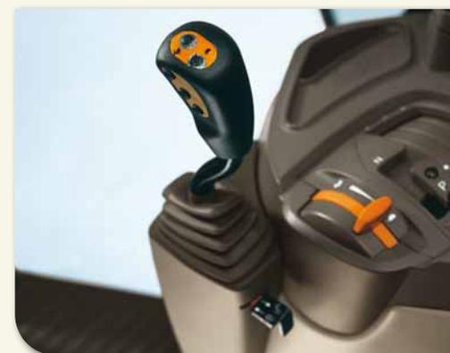
**Le monolevier intégré** est simple d'utilisation et bénéficie d'un espace dégagé dans la cabine. Il comporte les commandes des fonctions hydrauliques auxiliaires facilitant l'utilisation des équipements, tels que les grappins.
