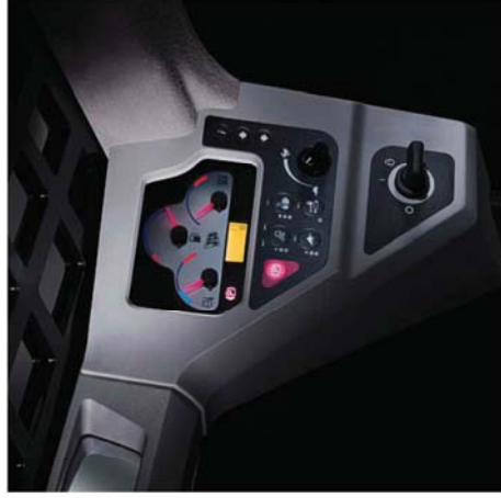
La console de droite est équipée des diagnostics de la machine, de l'accélérateur électronique et du démarrage.
