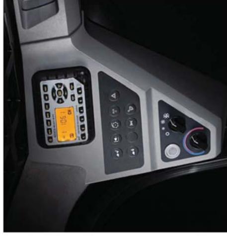
Les commandes en option de la machine sont disposées de manière ergonomique au niveau du toit, dans le champ de vision de l'opérateur.
