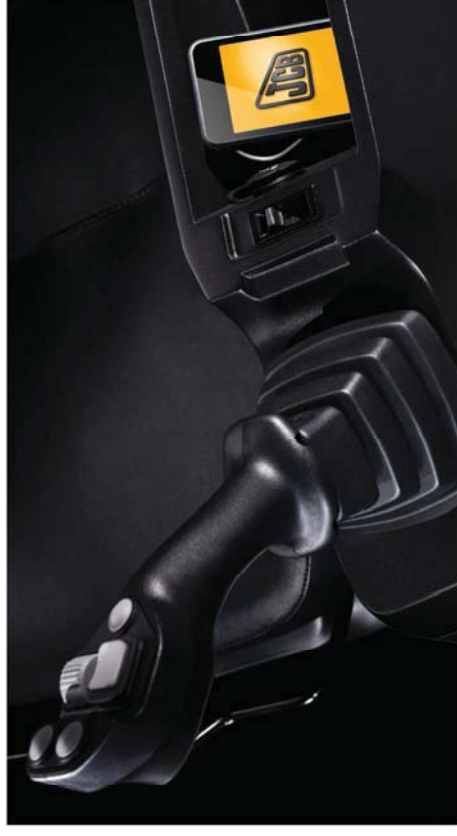
Un joystick multifonction en option permet à l'opérateur d'utiliser une plus grande gamme d'équipements hydrauliques. L'accoudoir de gauche comporte également un compartiment de rangement.
