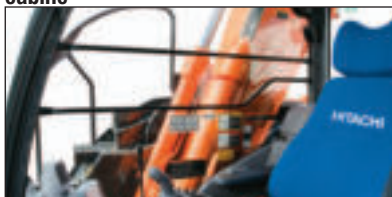
Barres de protection à droite de la cabine
